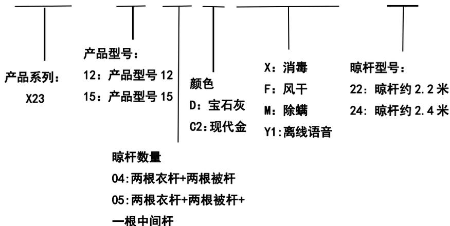
例: X23-1504DXFHY1-24 即广州晾霸智能家居科技有限公司生产的电动晾衣机 X23 系列, 产品型号 15, 两根衣杆+两根被杆及一根中间杆, 颜色为宝石灰, 照明系统采用 LED 平板灯, 带有风干、消毒等功能, 约为 2.4 米整杆晾杆。
